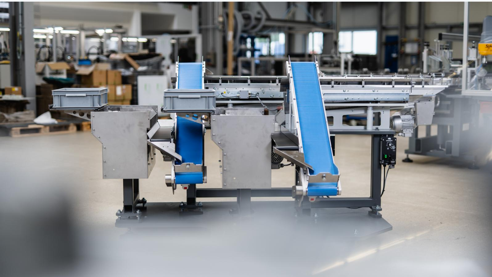
**Nicht für alle Bauteile ist ein Vibrationswendelförderer die optimale Bunker- und Zuführeinheit. Als Alternative bietet sich häufig eine Stufenhub-Zuführeinheit an. Aber auch die ist nicht für alle Bauteile geeignet.**
